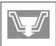
Simbolo che indica la posizione del tubo scarico serbatoio soluzione.
