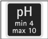
Etichetta con il valore del Ph del detergente da impiegare (solo per sistema CDS).
